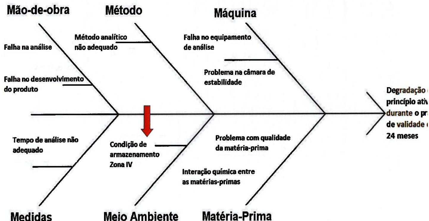
Figura 6: Diagrama de Ishikawa para investigação de causa referente degradação do princípio ativo
